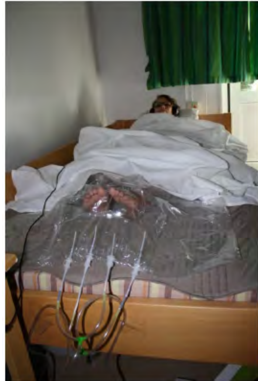
Bild 9. Försöksperson i plastpåse med fyra filter vid påsens ända.
