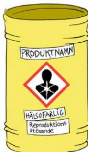
Figur 1. Exempel på förenklad arbetsplatsmärkning
