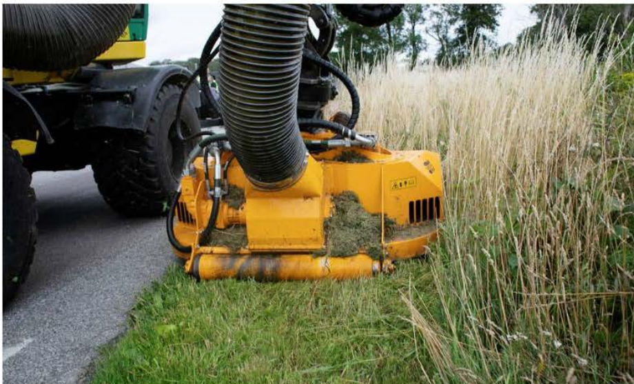
Slättermaskinen som används är ett specialdesignat fordon som suger upp biomassan samtidigt som växtligheten skärs av. Bild: Moa Dahlin
