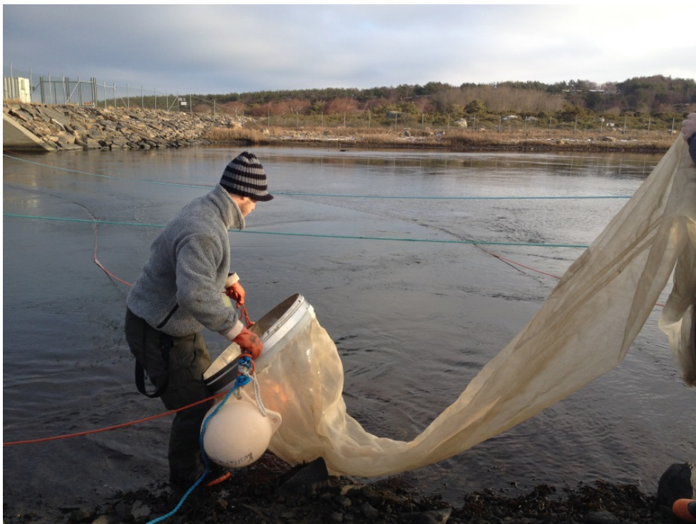
Provtagning med Bongohäv i intagskanal. Foto: Björn Fagerholm
